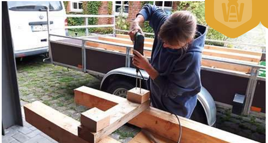
Abb. 06 - Für die neuen Untergestelle werden die zugeschnittenen Holzteile zusammengeschrubt. Foto: H. Schäfer
