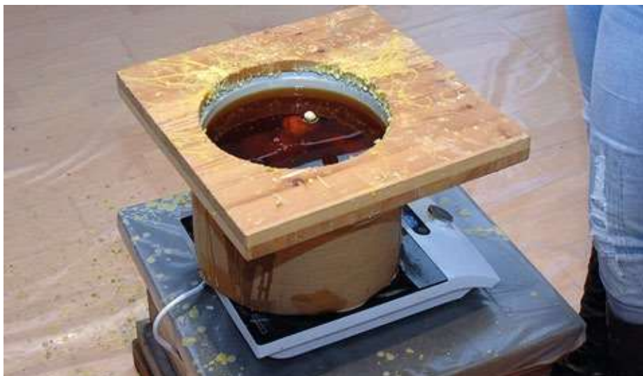
Abb. 09 - Für das „Kerzenziehen“ nutze ich als Wärmequelle eine Induktionsplatte, bei der die Temperatur genau regelbar ist. Foto: H. Schäfer
