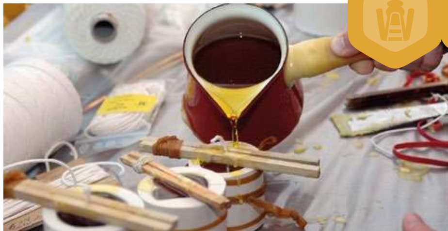
Abb. 11 - Gegossene Kerzen: Unterschiedlich dicke Kerzen benötigen unterschiedlich dicke Dochte. Foto: H. Schäfer
