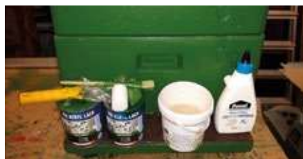
Abb. 11 - Reparaturmaterial: Holzsägemehl mit Holzleim als Spachtelmasse, Acrylfarbe auf Wasserbasis für den Außenanstrich.
